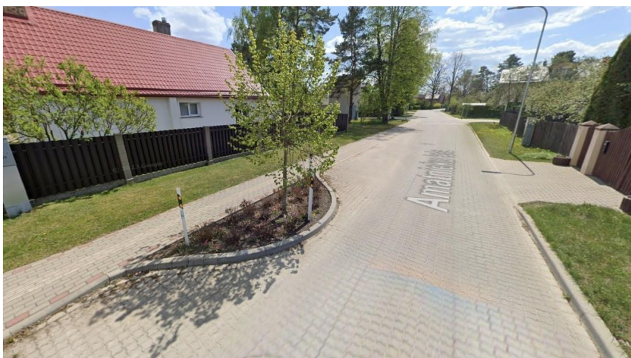
Attēls 62. Brauktuves telpas sašaurinājuma piemērs Amatnieku ielā, Ogrē
