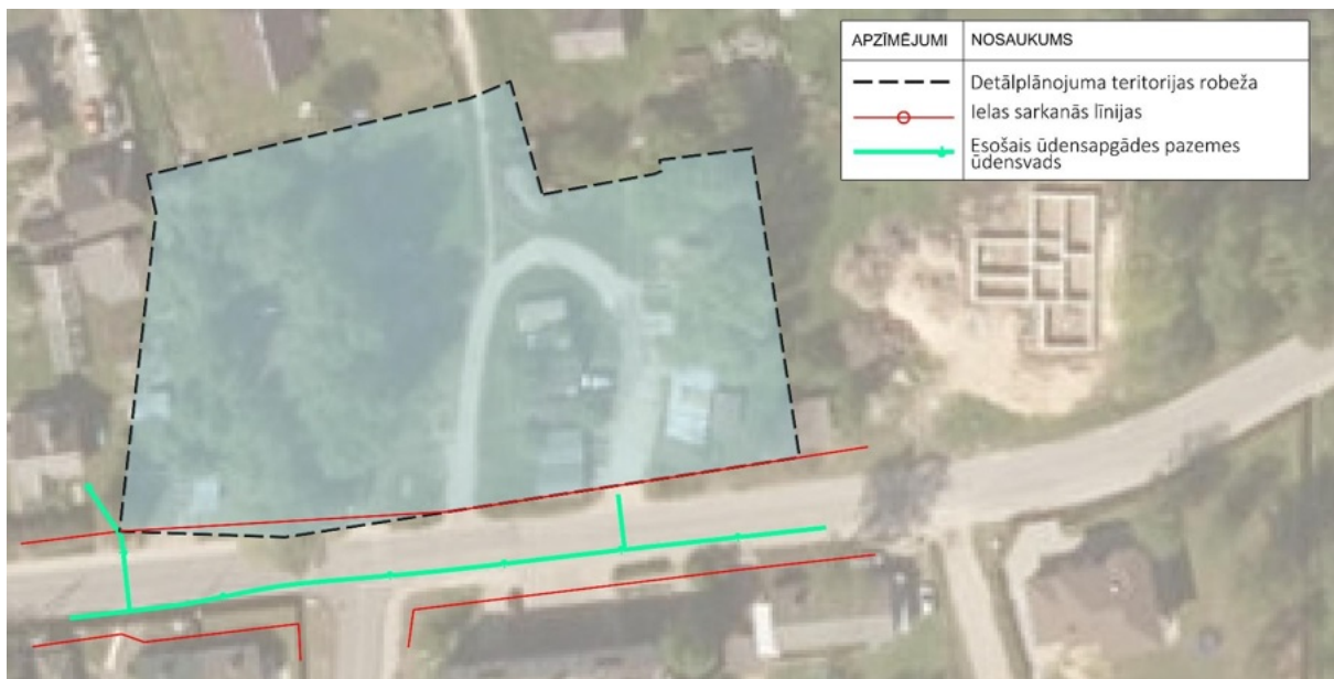
16. att. Ūdensapgādes shēma
