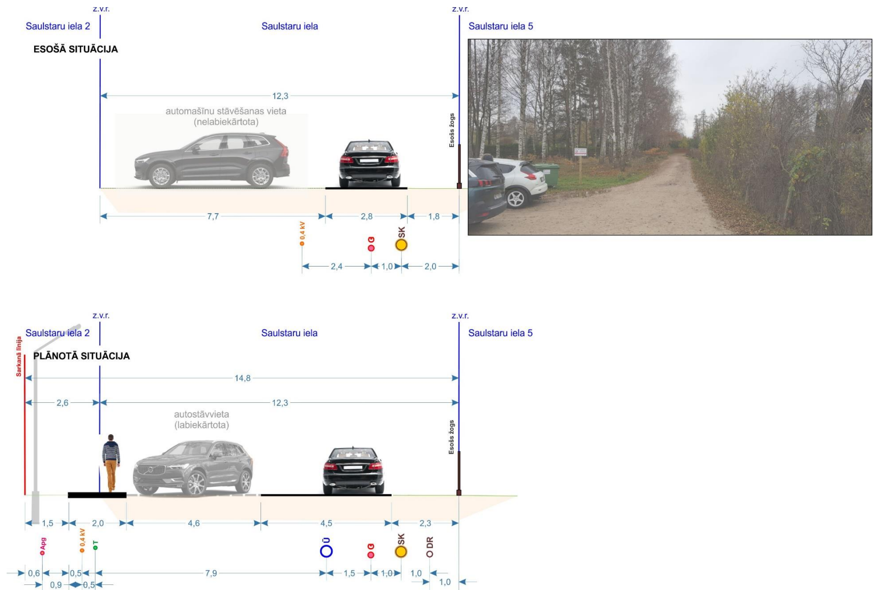
3.17.attēls. ESOŠAIS UN PLĀNOTAIS SAULSTARU IELAS ŠĶĒRSPROFILS (J)
